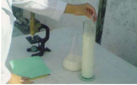
Şək.3.10. Südün sıxlığının areometrlə ölçülməsi.
